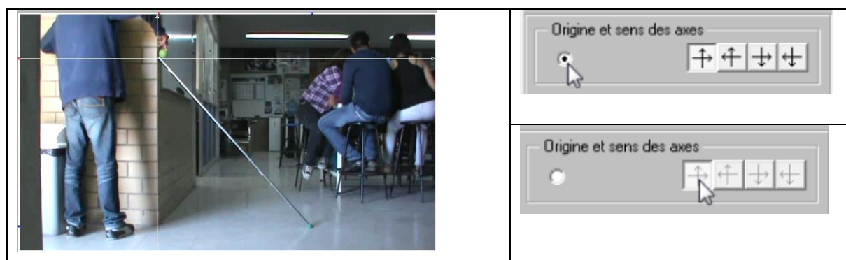
Figura 1: (Izquierda) Un estudiante deja caer una pelota por el plano inclinado. La captura de pantalla muestra los ejes cartesianos producido por el software AviMéca (derecha) y la configuración del sistema de referencia en el mismo (derecha).
